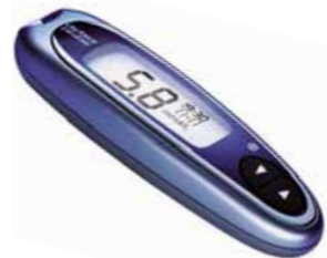
Рис. 24. Глюкометр: прибор для измерения уровня глюкозы в крови
